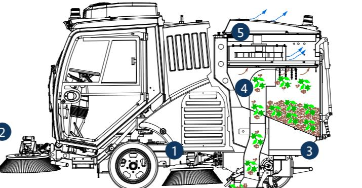
Los residuos se recogen gracias a la acción mecánica de los cepillos laterales (1) y el cepillo frontal (2), la boquilla de aspiración (3). Gracias a la corta longitud del tubo de aspiración (4), la turbina (5) trabaja con gran eficacia. El polvo se controla mediante el sistema de riego.
